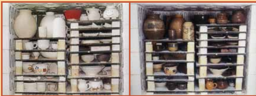
窯燒前電窯的內部情況
